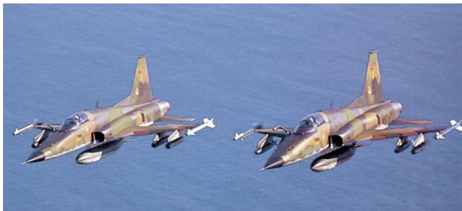
图 1.28 安装有空中加油管的巴西空军 F-5E
