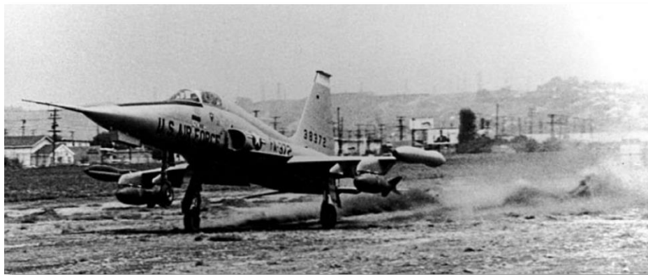
图 1.12 诺斯罗普 YF-5A (S/N 63-8372) 携带 2 枚 500 磅炸弹和翼尖邮箱在未铺装场地降落 (美国空军图片)
