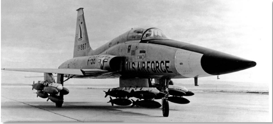
图 1.13 N-156F 原型机的 3 个挂架挂上了 250 磅炸弹
