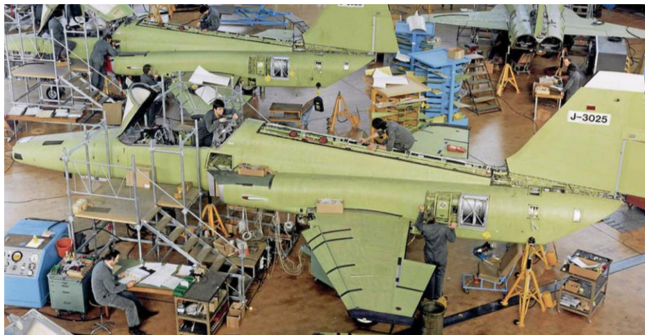
图 1.22 在位于埃曼的瑞士联邦飞机厂内组装中的 F-5
