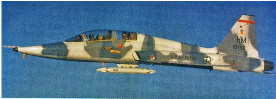
图 1.8 挂有训练弹发射巢的迷彩 T-38V
