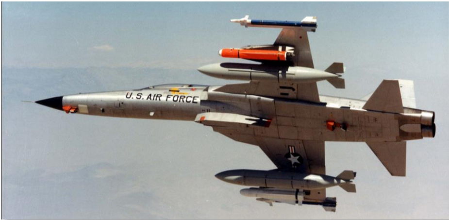
图 1.27 携带着副油箱、小牛导弹、响尾蛇导弹的 F-5F，机鼻下的红色盒子是武器使用记录相机
