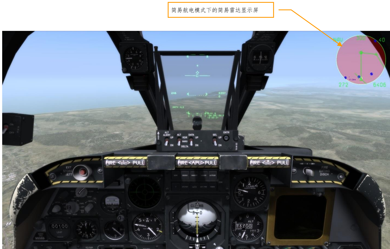
图 35. 简易航电模式下的简易雷达显示屏
