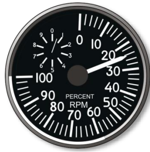
图 53. 发动机核心机转速表
