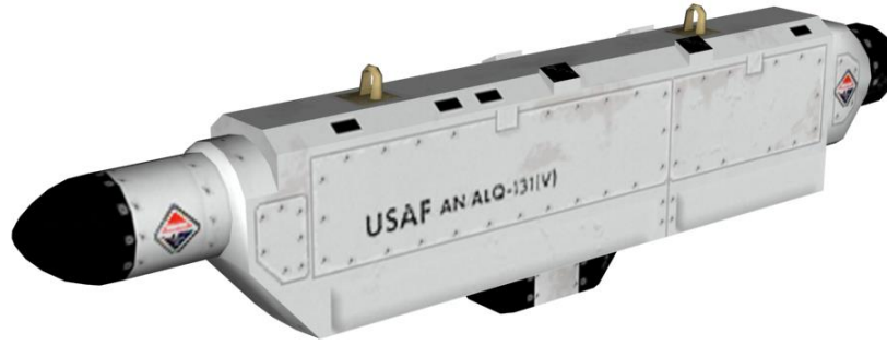
图 79. AN/ALQ-131 电子干扰吊舱
