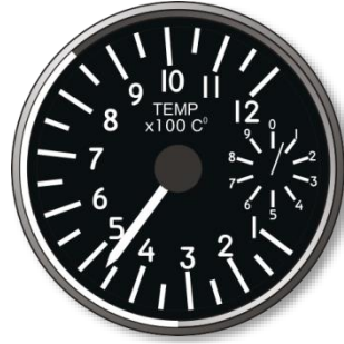
图 52. 发动机级间涡轮温度表 (ITTI)
