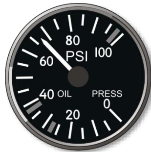
图 54. 发动机滑油压力表
